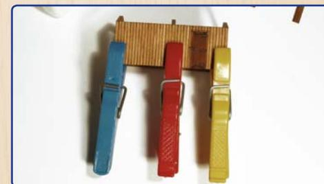
Klammern sind nützliche Helfer zum Fixieren der Bauteile während des Klebens.
